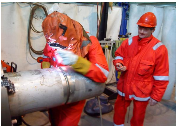
Måling av sveisehastighet med stoppeklokke
